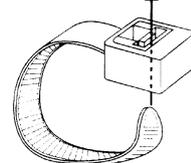
結束ベルトをコード類に巻きつけてから、先端を角穴に入れ、強く引き抜き固定してください。
