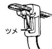
リピートタイをコード類に巻きつけてから、先端を角穴に入れ、強く引き抜き固定してください。
